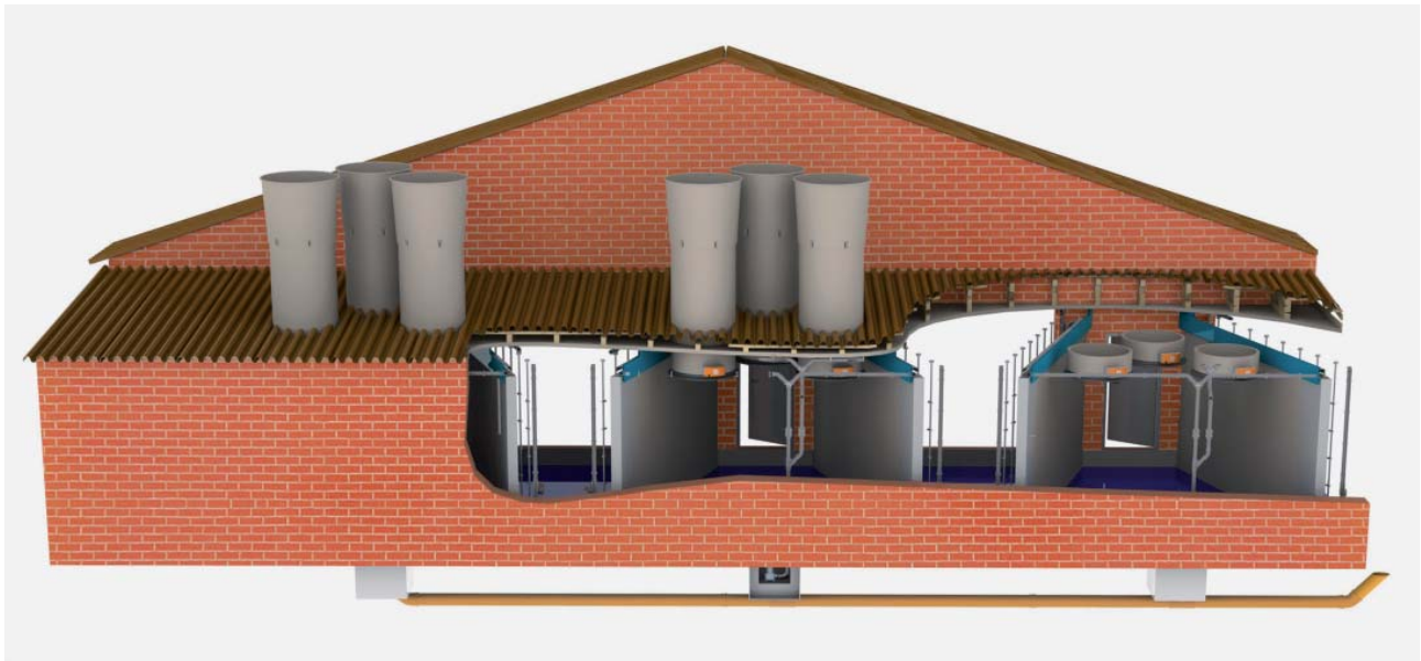
Bild 2: Schematische Darstellung des Abluftwäschers Magix-B
